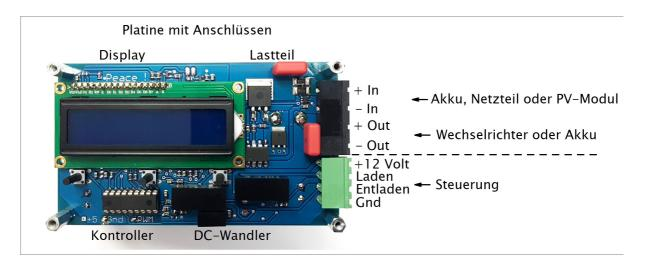
Am unteren Steckverbinder können 2 Relaiskontakte (z.B. Shelly Uni) zur Leistungssteuerung angeklemmt werden. Beim Schalten des jeweiligen Kontaktes gegen Masse (Gnd) wird die eingestellte Leistung für die Ladung oder Entladung etwa im Sekundentakt erhöht, solange der Kontakt geschlossen ist. Sobald der Kontakt offen ist, wird die Leistung wieder bis auf dem eingestellten Mindestwert herunter geregelt.
