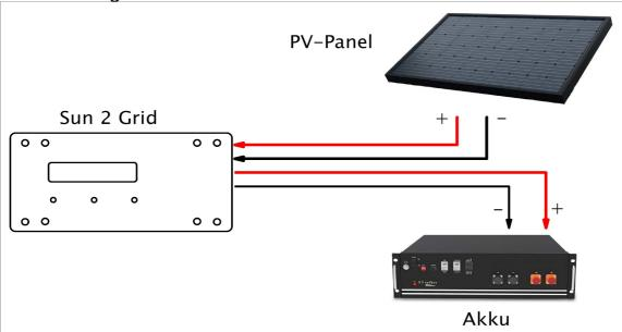
Die obere Plusleitung (+ In) wird über eine 15 Ampere – Sicherung an das Netzteil, das Panel oder an den Akku geklemmt. **Bitte klemme diese Leitung niemals ohne eine Vorsicherung an das Netzteil oder den Akku.** Bei Nutzung des Moduls als PWM-Lader kommt die Sicherung zwischen Sun 2 Grid und Akku.
